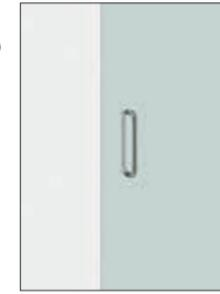
・ヒンジは強化ガラス専用ヒンジを使用します。(別途)
